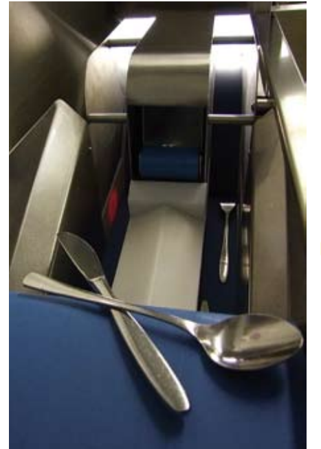
Innovative Automation: Beim Studentenwerk Karlsruhe weiß das Besteck alleine, wo es hinmuss durch die vollautomatische Bestecksortierung.
